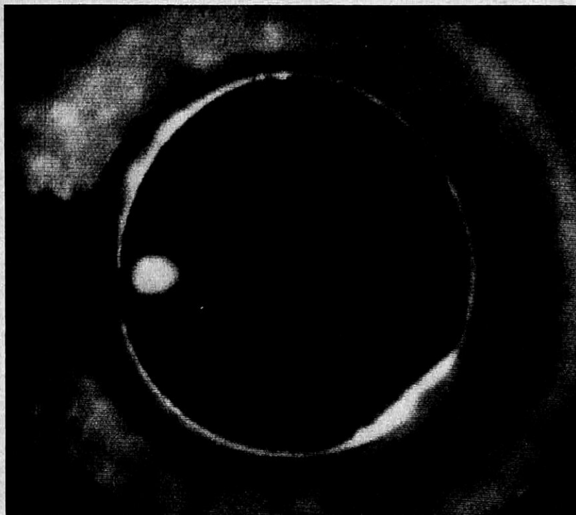
La goutte d'électricité est la tache brillante, ellipsoïdale, près du point d'application de la compression du cristal de Germanium par la vis que l'on distingue à gauche. Les autres luminosités sont, en bas à droite, celles provoquées dans le cristal par la lumière de la goutte selon un plan préférentiel du cristal et, tout autour du cristal, par la lumière diffusée. Le cristal mesure 4 mm de diamètre et la gouttelette faite d'un nuage de vingt mille milliards de charges positives (trous) et négatives (électrons) s'est étendue dans cette expérience jusqu'à 0,6 mm de diamètre. Cette expérience se passe à moins de deux degrés du zéro absolu. La lumière du laser qui provoque ce phénomène vient, sur ce cliché, de par derrière, au centre du cristal.
