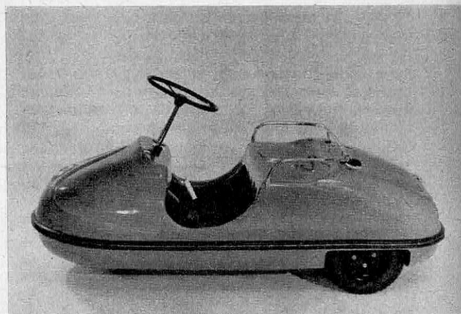
La petite voiture électrique Morrison à trois roues préfigure ce que pourrait être la microvoiture de ville. Le moteur est à l'arrière et l'alimentation est assurée par 12 batteries classiques que l'on peut recharger la nuit.
