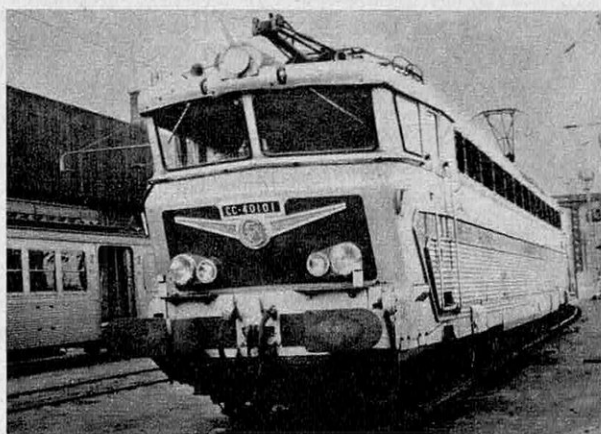
Cette « CC 40 101 » est une des quatre locomotives de la série capable d'atteindre les 240 km/heure. Sa puissance est de 5 230 ch) ou de 3 800 kW).
