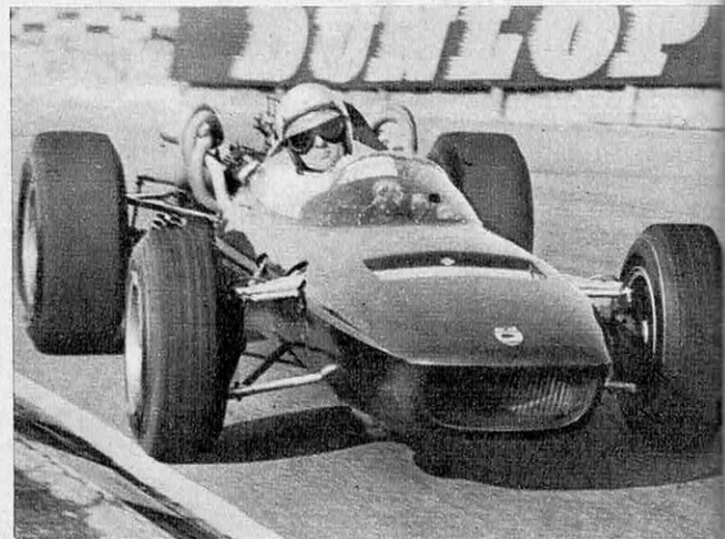
McLaren faisant des essais de pneus avec sa monoplace 1966 équipée pour la circonstance d'un V8 Oldsmobile de 4,7 litres.
