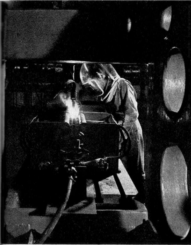
Le soudage en atmosphère d'argon. Il permet d'éviter les phénomènes d'oxydation.
