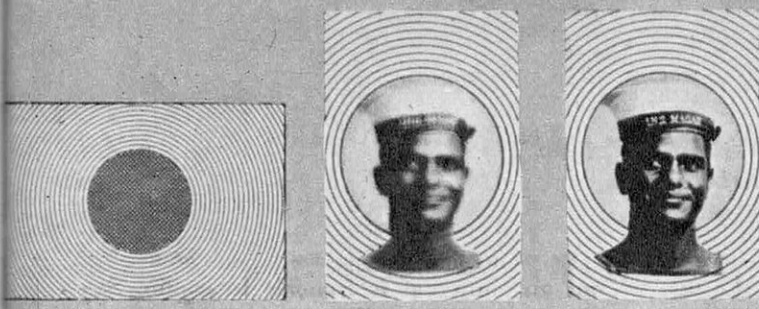
Sur l'Asahi-Pentax, une trame de fentes micrométriques extrêmement fines rend l'image floue au moindre déplacement de la mise au point.
