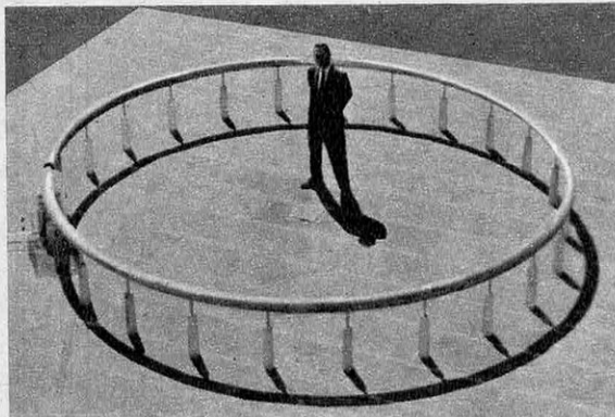
■ L'antenne en anneau de la Northrop Co. offre la même puissance d'émission qu'une antenne conventionnelle 30 fois plus haute. Son diamètre peut aller de 0,15 à 150 m.
