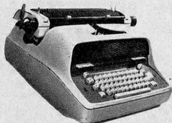
Toujours électrique, l'I.B.M. est cernée et surbaissée. Le modèle « Direction » est à espacement différentiel.
