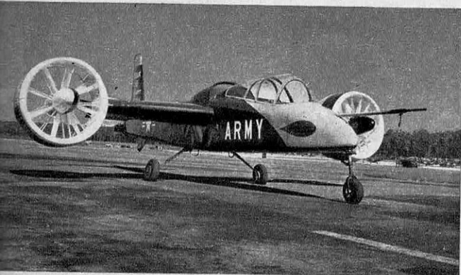
Le Doak est la plus récente tentative de l'aviation américaine pour réaliser un appareil de liaison à hautes performances, en utilisant la « convertibilité » des rotors.
