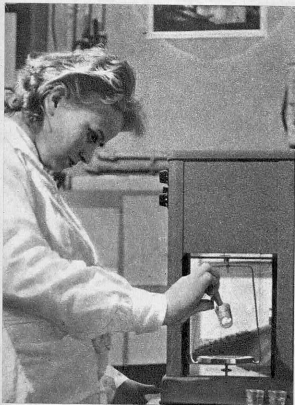
Pesée finale au centième de milligramme du perchlorate de potassium sur la balance Metler.
