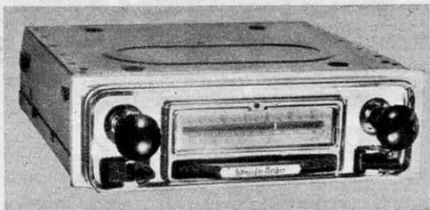
émetteur assez puissant, elle provoque une tension de déclenchement qui immobilise le mécanisme dans la position qu'il occupait. On voit, à gauche, le récepteur proprement dit avec G.O. et P.O. et, à droite, l'adaptateur O.C. à 6 bandes étalées (Schneider). Une commande à distance peut être placée au gré de l'utilisateur.
