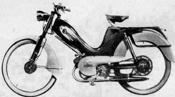
cadre embouti et soudé avec réservoir 5 litres
