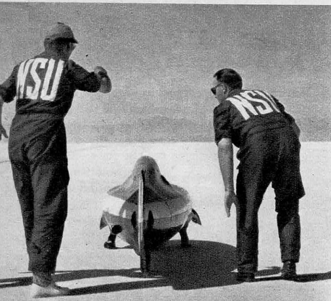
Un départ du « Baum II ». Les pieds du pilote dépassent encore par les deux trappes ce qui, à l'arrêt, lui permet de maintenir l'engin en équilibre.
