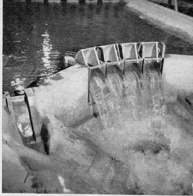
Le barrage de Monteynard est la maquette la plus récente. Il est ici à son plein débit.
