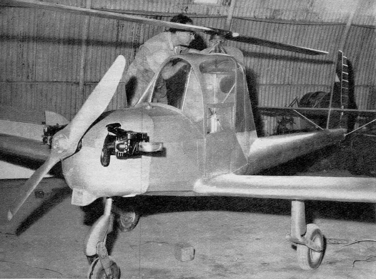
L'AVION-SCOOTER italien du C t Mario de Bernardi, dont le rotor n'est débloqué que pour l'atterrissage, décollé et atterrit en 50 m. A 150 km/h, il consomme 4 l/100 km. Prix : 500.000 fr.
