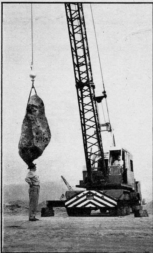
PAS UN PLI AU CHAPEAU : deux tonnes de roc ont été descendues au bout d'un filin de 15 m jusqu'à frôler la tête d'un démonstrateur.
