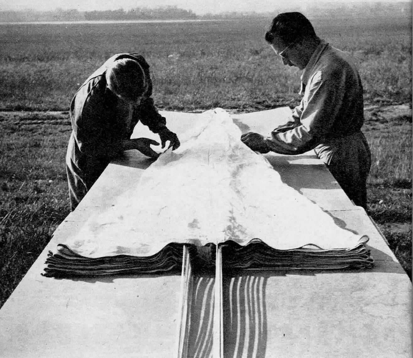
1 Sur la table de pliage, le parachute est étalé fuseau sur fuseau par l'élève, devant le moniteur.
