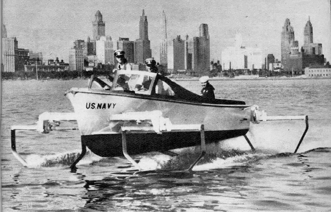
↓ **L'HYDROFIN HOOK** adaptable sur les bateaux à moteur classiques de 3,5 à 5 mètres, augmente leur vitesse de 40 %. Pour aborder sur les plages, il suffit de relever vers l'arrière moteur et ailes.
