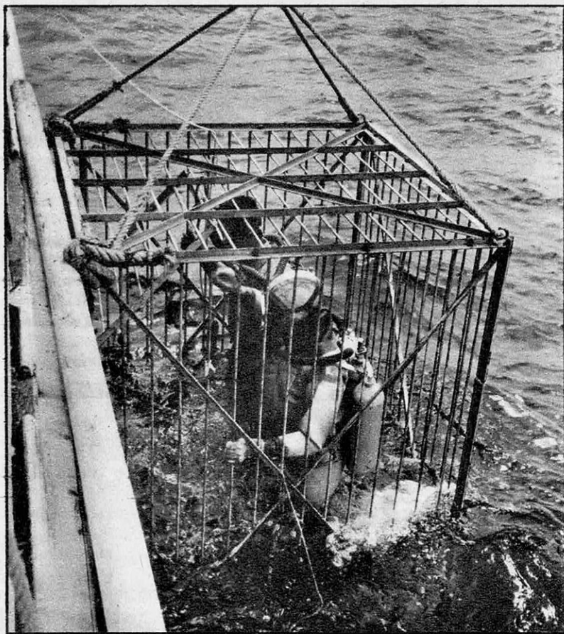
UNE CAGE ANTI-REQUINS protège les géologues de la British Petroleum Company, équipés du scaphandre autonome du commandant Cousteau, au cours de leurs plongées dans le golfe Persique. Ils étudient directement la possibilité de nouveaux forages sous-marins. Leur plongée peut durer deux heures par 30 m de fond.
