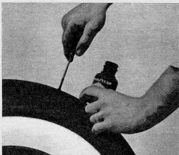
LE BOUCHON préconisé par Goodyear pour des trous allant jusqu'à 6 mm se place, aussi, sans qu'il soit nécessaire de démonter la roue.
