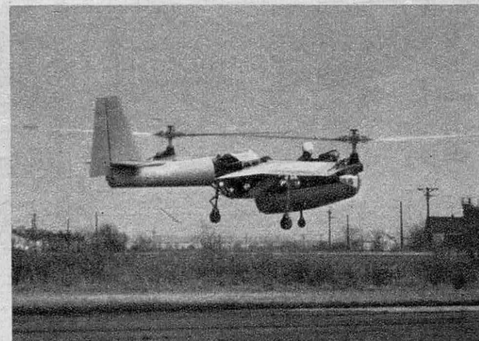
LE TRANSCENDENTAL 1-6 possède deux rotors animés par un moteur Lycoming de 160 chevaux. Son maniement est très simple : un pilote l'a fait voler presque sans apprentissage.
