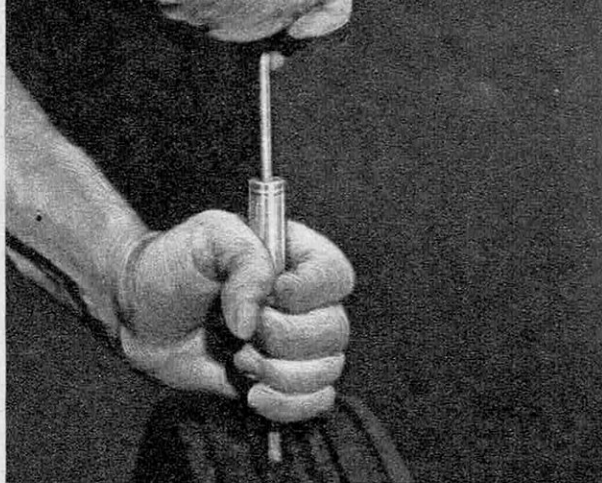
LE PISTOLET A PNEUMATIQUES est utilisé pour des trous allant jusqu'à 3 mm, avec les pneus qui n'ont pas de couche de butyl pâteux.
