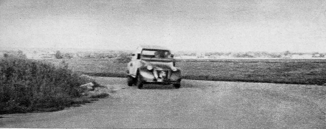
2 CV CITROËN NORMALE dans un virage non relevé : la voiture s'incline à l'extérieur.
