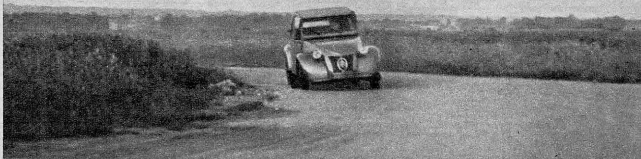
2 CV SERVO-SUSPENDUE dans le même virage, à 80 km/h. La voiture s'incline à l'intérieur.
