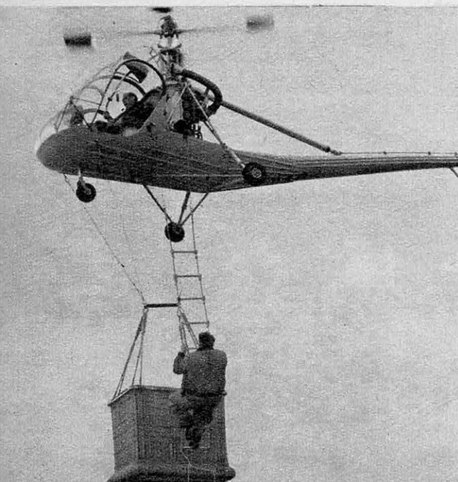
Les « Hiller », de la garde de sauvetage suisse, sont munis de brancards pour le transport des blessés ou d'une corbeille dans laquelle on place les chiens dressés pour les découvrir sous la neige. Leur plafond avec un passager n'est que de 2 500 m.
