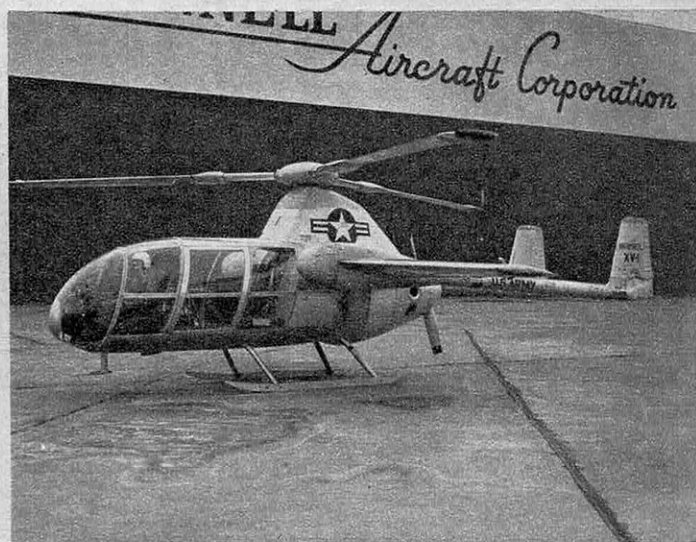
LE MCDONNELL XV-1 dispose d'un rotor pour s'élever et d'une hélice située à l'arrière de l'appareil pour se propulser. Un réacteur logé dans le fuselage fournit la puissance nécessaire.
