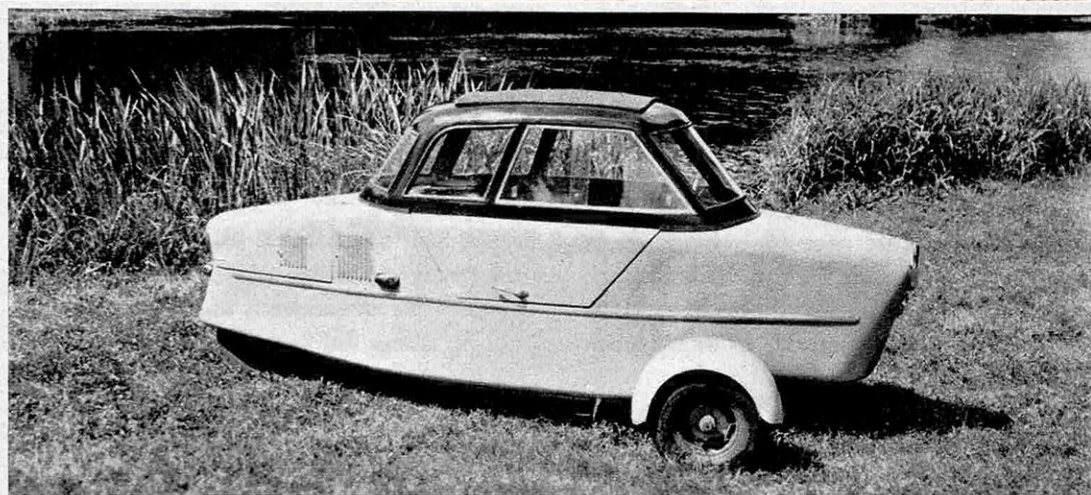
La grande finesse aérodynamique apparaît sur cette vue qui montre l'absence de toutes saillies en dehors des projecteurs.
