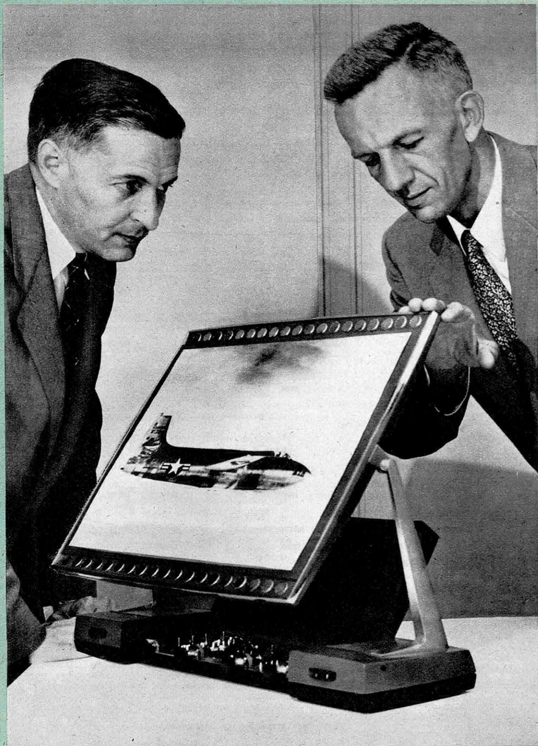
Le récepteur de télévision 1960 tel que l'envisagent les techniciens américains : l'écran, réduit à un panneau, peut aussi bien s'accrocher à un mur ; le poste auquel il est relié par fil prend lui-même grâce aux transistors le minimum de place.
