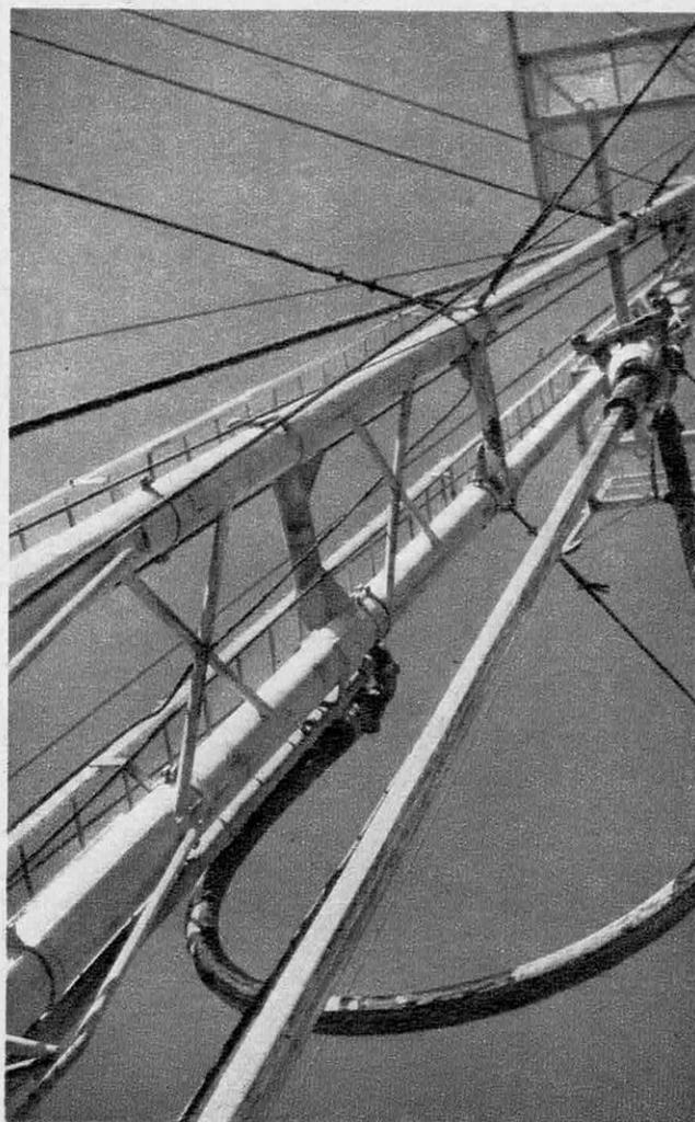
Le tuyau amenant les boues lubrifiantes à l'intérieur des tiges de forage est fixé à la tête d'injection qui descend au fur et à mesure que les tiges s'enfoncent dans le sol. Arrivée près de la « table de rotation », à droite, la tête est remontée en haut d'une nouvelle tige, rallongeant la précédente.
