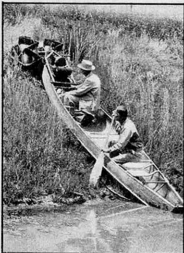
barcation étrange qu'on voit sur notre photographie : c'est un vrai bateau, fait pour l'eau, mais qui peut se déplacer sur terre grâce à un système de roues motrices à l'avant et de skis à l'arrière. Destiné au transport de matériel sismographique dans les marais du Venezuela, il peut véhiculer des charges considérables sur toutes les surfaces : liquides, solides, et même visqueuses.
