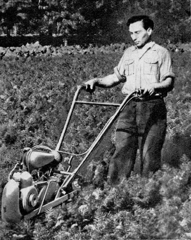
● Ce petit monoroue 1,5 ch, écarte les fanes de carottes de son carter en proue et remorque une lame bineuse qui sarcle entre deux rangs (Staub).
