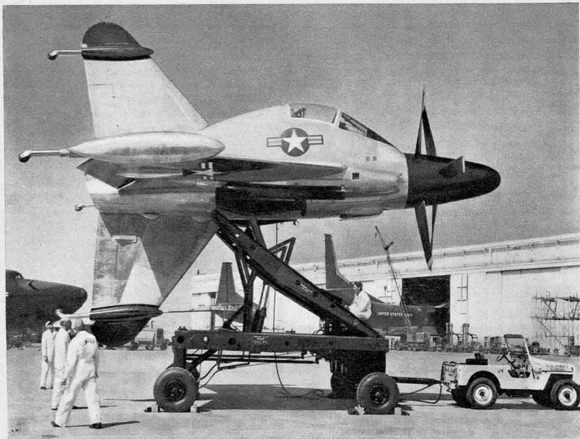
Le Convair XFV-1 en position de vol horizontal, ou de transport sur sa remorque-grue.
