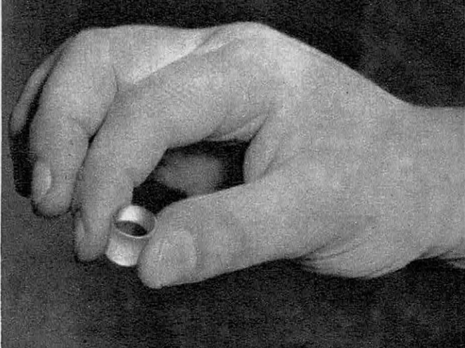
● Ce petit hublot de quartz constitue le voyant de la chambre où s'exercent des pressions de 12000 kg/cm 2 .
