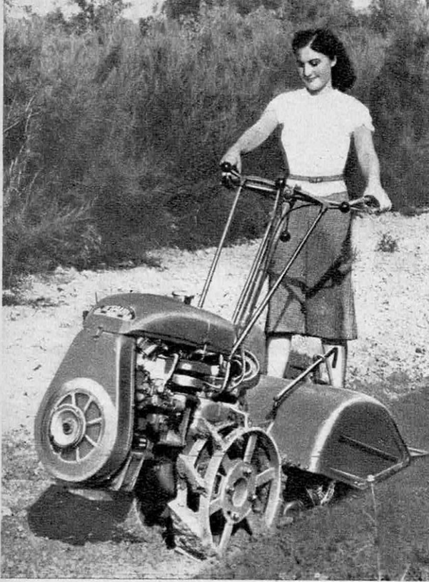
● Un 4 ch en train de fraiser. La fraise (45 cm de large), sous le carter, tourne à grande vitesse et laisse la terre ameublie à 20 cm de profondeur (Staub).
