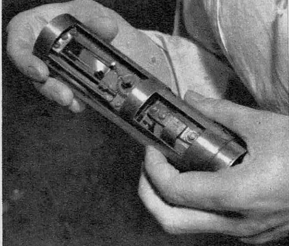
● L'appareillage est à l'échelle des chambres d'expérience : ce régulateur à arc a 30 mm de diamètre.
