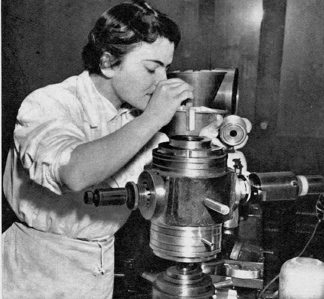
CHAMBRE A EXPÉRIENCES AUTOFRETTÉE CONVENANT A DES ULTRAPRESSIONS DE 15 000 kg/cm
