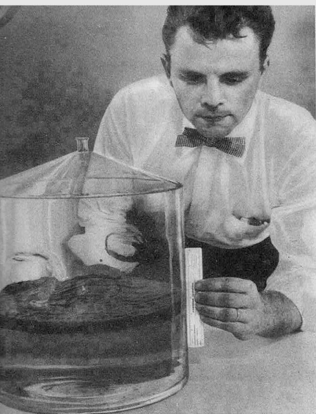
● Dans le réservoir, la mousse de microballons constitue, au-dessus du pétrole, un véritable toit flottant absolument étanche, qui suit les fluctuations du liquide et s'oppose à son évaporation.
