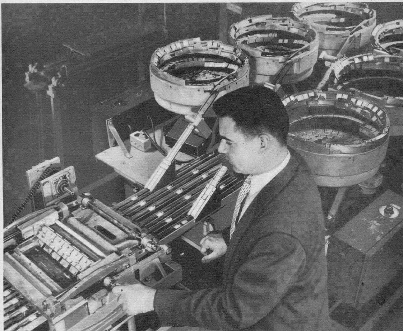
A GAUCHE, LES CIRCUITS SONT IMPRIMÉS SUR LES PLAQUETTES QUI SORTENT DES CUVES VIBRANTES
