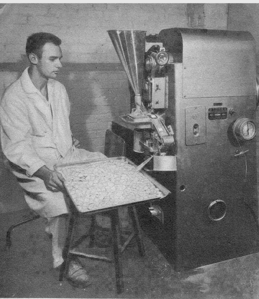
**A** La machine qui, à partir d'un mélange de talc, de kaolin et de carbonate de baryum, fabrique deux mille trois cents plaquettes à l'heure.
