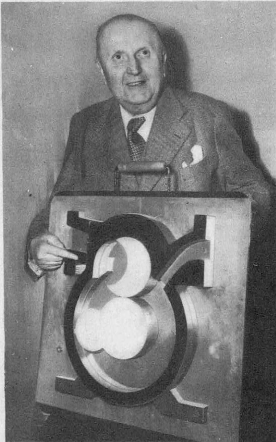
● M. René Planche montre la maquette de sa « turbine volumétrique » Grand Prix de l'Invention 1954. Déjà réalisée en compresseur, elle peut fonctionner en moteur soit à l'essence, soit au gas-oil.
