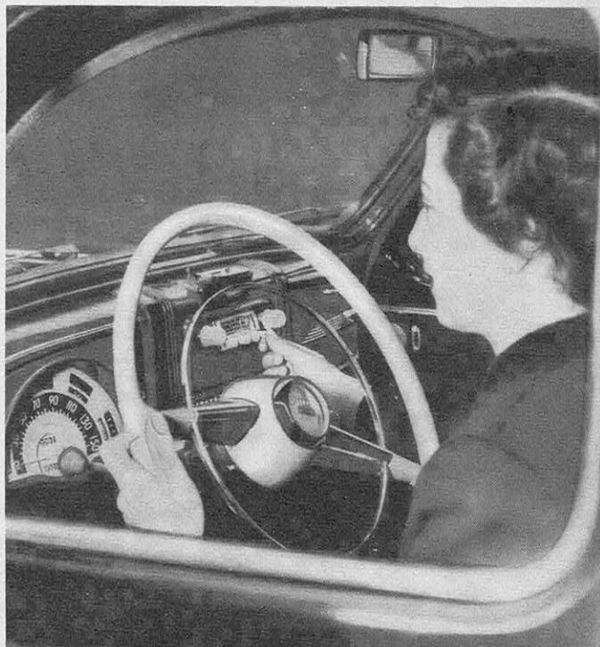
Sur ce poste, les principales émissions sont ➔ obtenues en appuyant simplement sur un bouton. Ce réglage ne détourne pas l'attention du conducteur mais sa précision ne peut être absolue.
