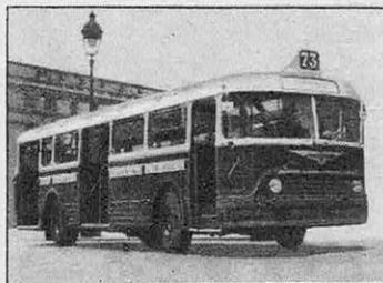
ports Parisiens vient de mettre en service : il a trois portes, une pour la montée et deux pour la descente. L'amélioration de confort qui en résulte est appréciable : c'était une pénible sujétion que d'avoir, pour gagner la sortie, à traverser d'un bout à l'autre un véhicule bondé.
