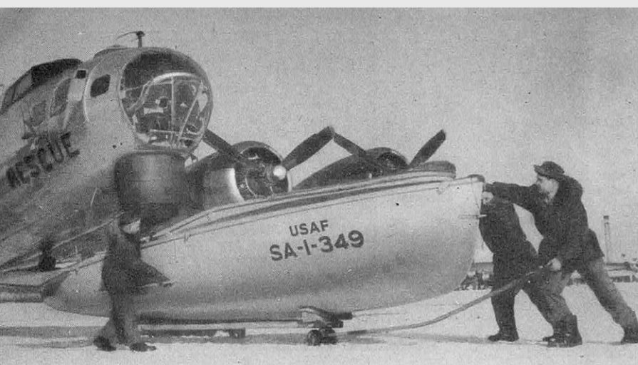
← Mise en place de l'embarcation de sauvetage qui sera larguée par une des « Fortresses Volantes » d'Anchorage, et contenant vivres, vêtements et chauffage.
