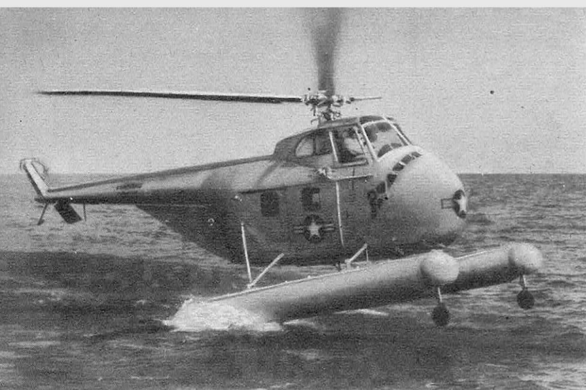
← Le décollage d'un hélicoptère amphibie Sikorski S-55 de sauvetage, à flotteurs et roulettes, capable d'enlever dix passagers en plus de son pilote.
