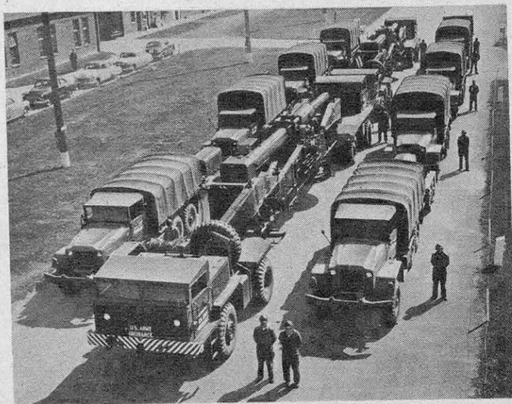
● Une batterie autonome d'artillerie atomique comprend deux canons de 280 mm, quatre tracteurs et huit camions ; ne comportant que des véhicules tous terrains, elle peut atteindre 55 km/h. L'ensemble tube-affût, qui pèse 85 t, repose en position de route sur les plates-formes de deux tracteurs. 435
