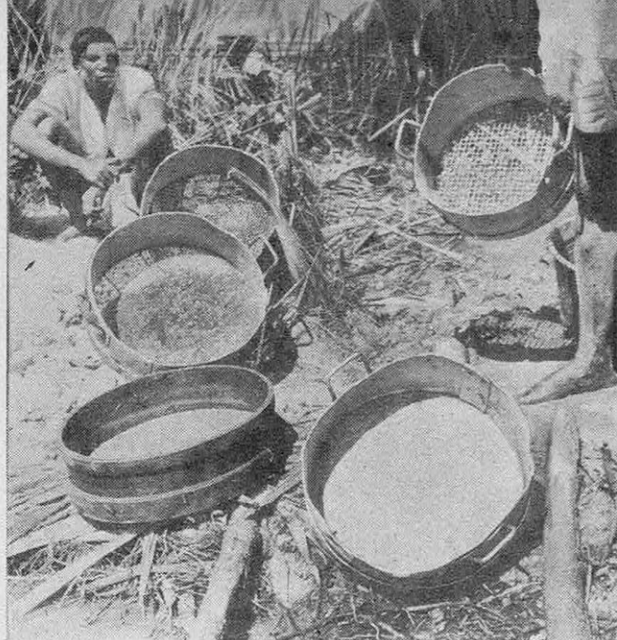
● Le matériel type utilisé à la prospection se compose de ces tamis dont la trame laisse des vides de 1, 2, 4 ou 6 mm, permettant de classer le gravier en diverses grosseurs. Les vibrotamis sont réservés à l'exploitation.
