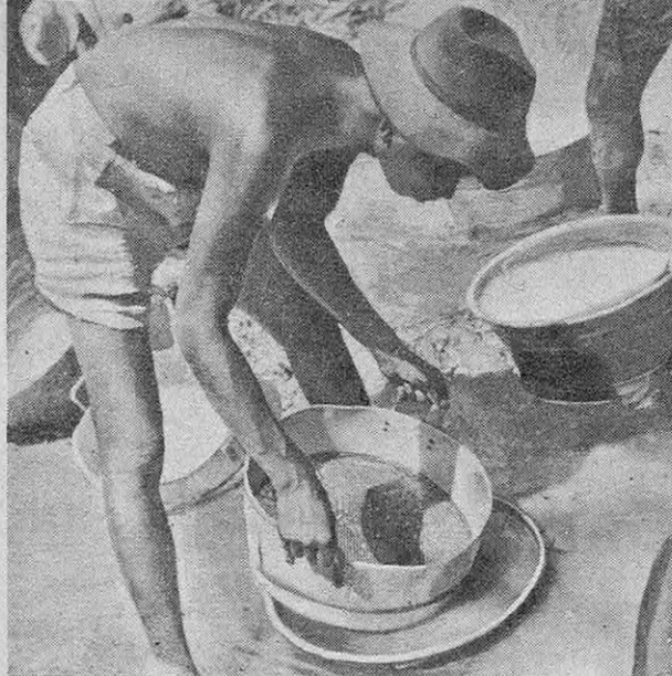
● Le gravier qui a été classé est alors traité au « gravitator » : tamis à mailles de 0,8 mm que l'on anime d'un mouvement de rotation, juste au-dessous de la surface unie d'un ruisseau.
