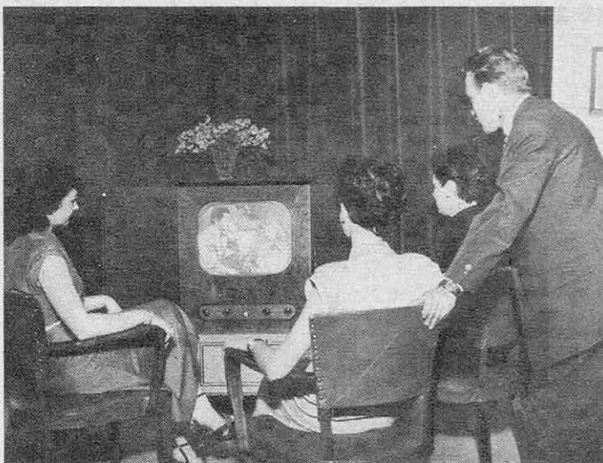
● Téléviseur familial à projection comportant un écran de 58 cm de diagonale. Dans ce type d'appareil, au lieu d'être projetée, l'image est vue par transparence ; l'écran spécial a l'aspect du verre dépoli.
