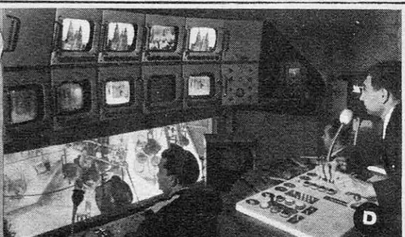
dans un local spécial (C) ; enfin la régie de contrôle (D), ayant une vue directe sur le studio en service, sélectionne la meilleure prise de vues et dirige les diverses émissions.
