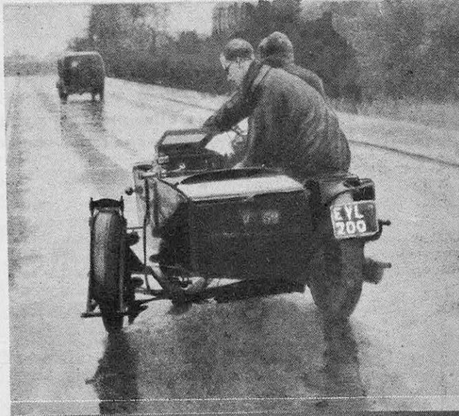
● Side-car équipé, pour mesurer la glissance des routes mouillées, d'une roue qui chasse et dont tous les écarts sont enregistrés. (Documentation « The Motor ».)
