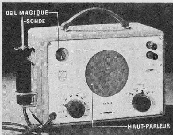
● La sonde de l'analyseur dynamique sonore et visuel pour le dépannage rapide permet d'ausculter les différents circuits d'un radiorecepteur pendant son fonctionnement.
