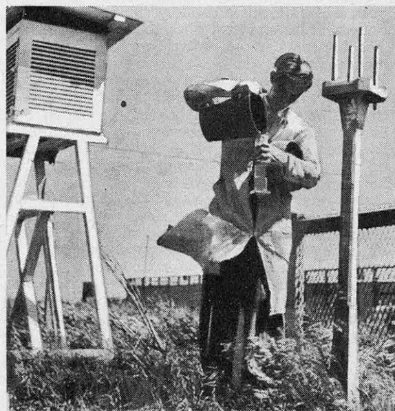
Un parc météorologique en rase campagne : la mesure → de la température (faite dans l'abri à 2 m au-dessus d'un sol gazonné) et la mesure de la pluie (effectuée ci-contre) donnent toutes garanties : si les thermomètres de ces stations témoignent d'un réchauffement, celui-ci est réel.
