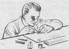
Régler une montre Omega c'est adapter le ressort spiral à son balancier, de telle sorte que ce dernier produise exactement *5 vibrations à la seconde*, soit 18.000 à l'heure.\*
