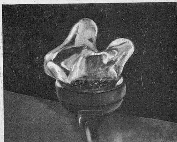
...comporte un embout modelé en matière plastique fabriqué d'après moulage du conduit auditif (Phonak). 25
