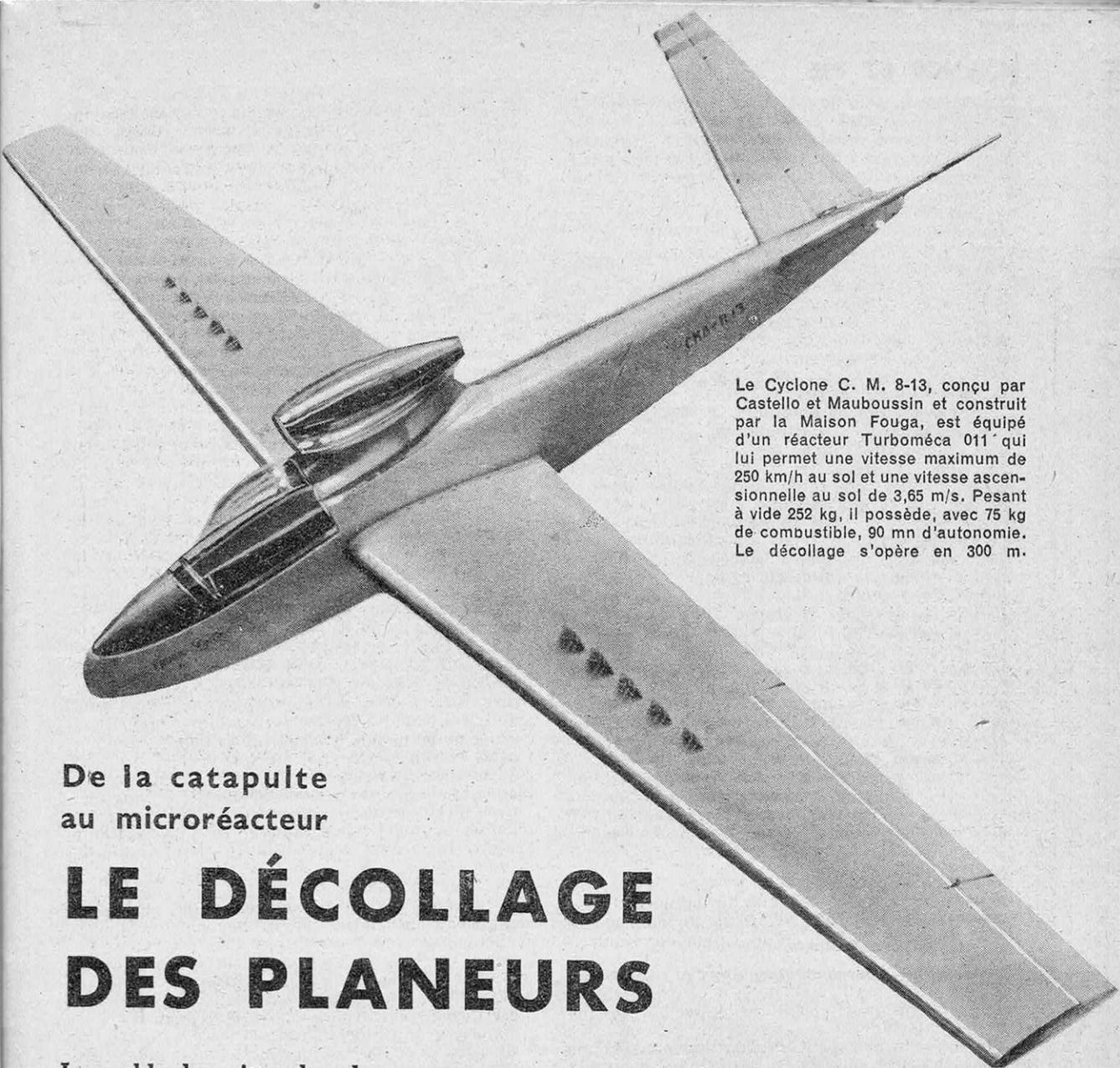
Le Cyclone C. M. 8-13, conçu par Castello et Mauboussin et construit par la Maison Fouga, est équipé d'un réacteur Turboméca 011 qui permet une vitesse maximum de 250 km/h au sol et une vitesse ascensionnelle au sol de 3,65 m/s. Pesant à vide 252 kg, il possède, avec 75 kg de combustible, 90 mn d'autonomie. Le décollage s'opère en 300 m.
