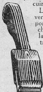
L'appareil en bois verni, monté avec un porte-lame en acier chromé muni d'une lame en acier spécial trempé, permet tous les usages. C'est le grattoir parfait pour l'amateur et le professionnel. Il ne nécessite aucun réglage. La lame peut se réaffûter plus de cent fois avec une lime douce. Pour la remplacer, il suffit de la faire glisser du porte-lame.
