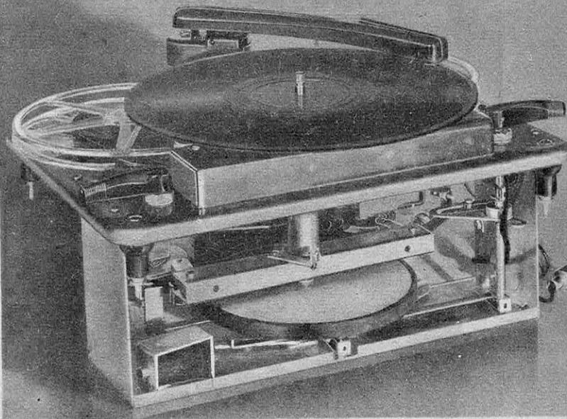
Fig. 8 et 9 : La machine « Twin-Trax » utilise successivement les deux faces d'un ruban plastique à enduit magnétique, de 6 mm de largeur. Les bobines de 17 cm de diamètre permettent une heure d'enregistrement continu à la vitesse de 77 cm/s. L'enroulement peut se faire à grande vitesse dans les deux sens. A droite, on voit l'intérieur d'un appareil semblable, équipé de plus d'un pick-up normal et d'un tourne-disque. (Amplifier Corp. of America.)
