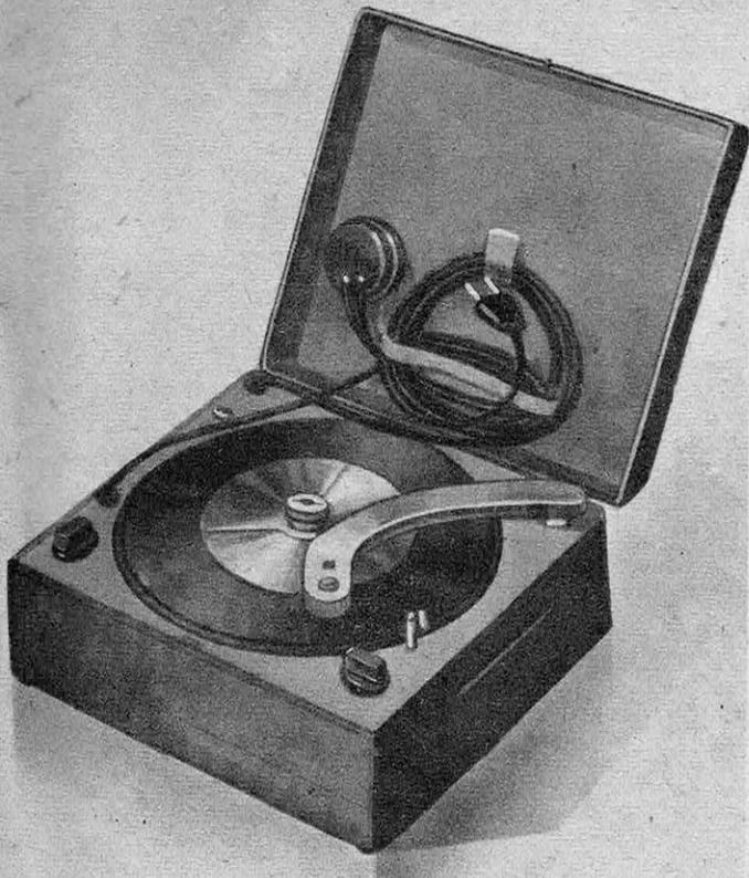
Fig. 3 : La machine « Mail-A-Voice » utilise des disques en papier recouverts d'un enduit magnétique qui permettent un enregistrement de 3 minutes de durée. Le bras portant la tête d'enregistrement ou de reproduction est guidé par une spirale gravée sur le plateau de l'appareil. (Brush Development Corporation.)
