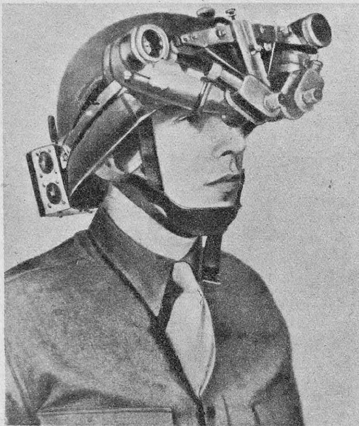
FIG. 2. — LE « SNOOPERSCOPE » A RAYONS INFRAROUGES
