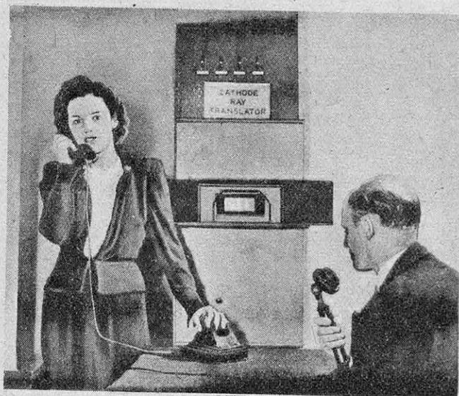
FIG. 7. — L'OSCILLOGRAPHÉ CATHODIQUE APPLIQUÉ A LA TRADUCTION VISUELLE DE LA PAROLE
