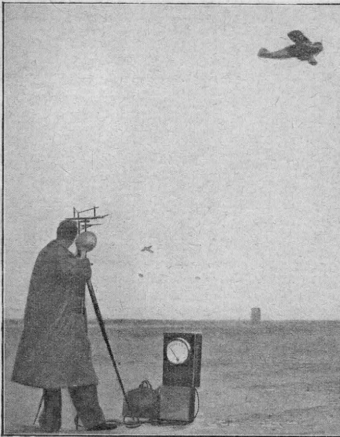
FIG. 11. — L'APPAREIL AMÉRICAIN « SENSYTROL » A ONDES ULTRACOURTES AURAIT PERMIS LA DÉTECTION DES AVIONS A UNE DISTANCE DE 14 KM
