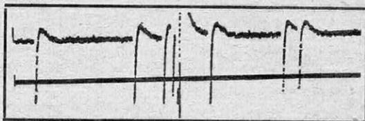
FIG. 3. — EXEMPLE D'UN ENREGISTREMENT OBTENU AVEC L'APPAREIL DE LA FIGURE 2. Chaque crochet correspond à l'arrivée sur l'électrode d'un des corpuscules provenant de la désintégration.
