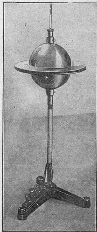
FIG. 6. — PETIT ÉMETTEUR POUR ONDES TRÈS COURTES COMPRENANT UN CIRCUIT OSCILLANT SPHÉRIQUE SURMONTÉ D'UNE ANTENNE
