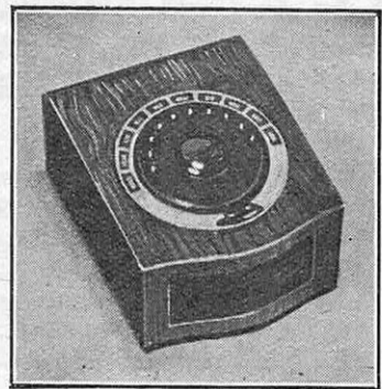
FIG. 3. — LA « BOITE MYSTÉRIEUSE » DE PHILCO, ORGANE DE COMMANDE A DISTANCE D'UN RÉCEPTEUR
