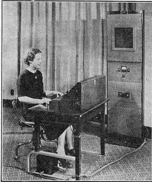
FIG. 13. — LE « VODER », MACHINE PARLANTE ÉLECTRIQUE, PERMETTANT LA SYNTHÈSE DE TOUS LES SONS ET DE LA PAROLE HUMAINE
