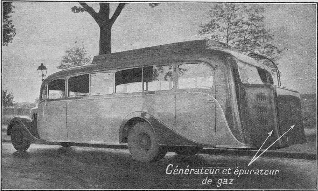
FIG. 1. — AUTOCAR ÉTUDIÉ POUR LA MARCHÉ AU GAZ DE GAZOGÈNE
