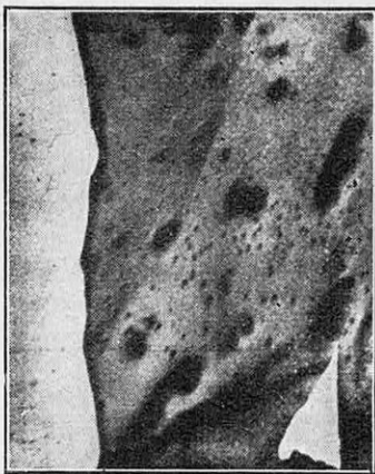
FIG. 10. — DE L'OR COLLOÏDAL EN SUSPENSION DANS UN FILM DE GÉLATINE, VU AU MICROSCOPE ÉLECTRONIQUE AVEC UN GROSSISSEMENT DE 2 900 FOIS
