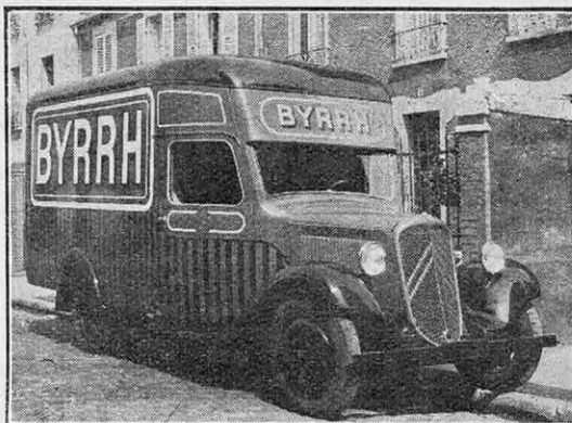
FIG. 3. — FOURGON « CITROËN-23 » DONT LE POIDS DE LA CAISSE A ÉTÉ RAMENÉ DE 800 A 400 KG GRACE AUX ALLIAGES D'ALUMINIUM L'augmentation de charge utile résultant de l'allègement (400 kg sur 1 500 kg) est de 20,6 %.
