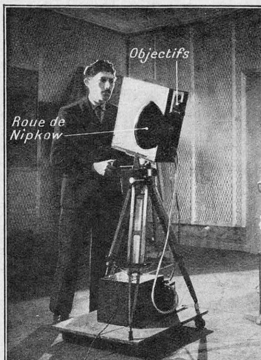
FIG. 1. — PRISE DE VUE DANS LE STUDIO DE LA COMPAGNIE FRANÇAISE DE TÉLÉVISION AU MOYEN DE LA CAMERA A ROUE DE NIPKOW, SYSTÈME BARTHÉLEMY. L'EXPLORATION DU SUJET EST INFÉRIEURE A 180 LIGNES
