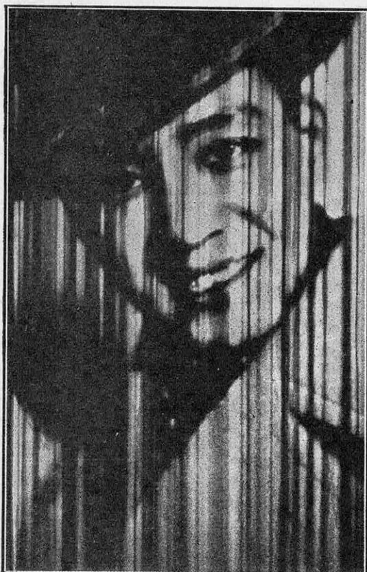
FIG. 1. — INFLUENCE DU FADING SUR LA TRANSMISSION D'IMAGES PAR LA MODULATION ORDINAIRE EN AMPLITUDE
