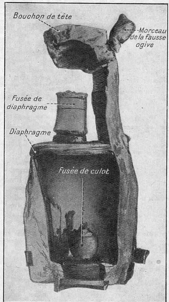
FIG. 2. - CE FRAGMENT D'OBUS DE LA « GROSSE BERTHA » A PERMIS DE RECONSTITUER LA FORME ET LES DÉTAILS DU PROJECTILE
