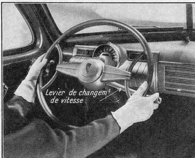
FIG. 10. — LE NOUVEAU VOLANT DE LA VOITURE « OLDSMOBILE » PERMET, PAR LA DISPOSITION PARTICULIÈRE DE SES BRAS, D'APERCEVOIR CONSTAMMENT LES APPAREILS DE BORD. Le levier de changement de vitesse, que la conductrice tient entre les doigts, est placé au-dessous du volant, ce qui dégage complètement les places avant.
