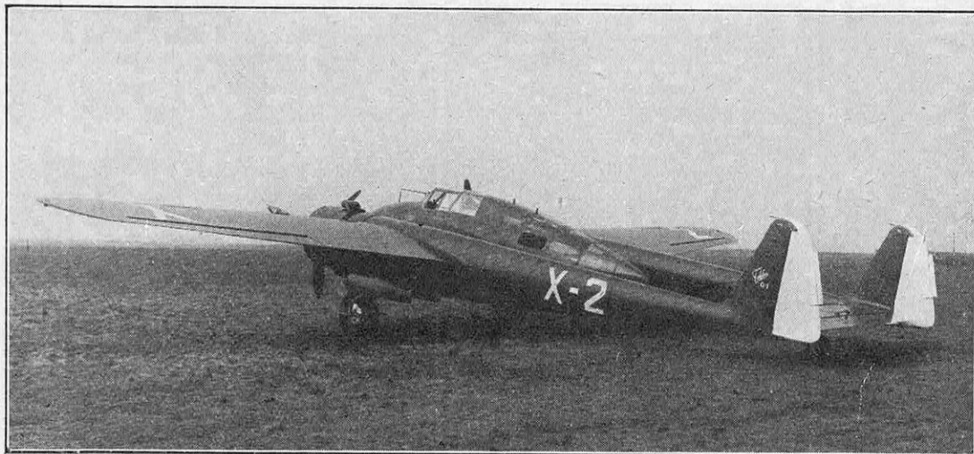
FIG. 2. — LE PREMIER APPAREIL ÉTUDIÉ SPÉCIALEMENT POUR REMPLIR LES MISSIONS DÉVOLUES À L'AVIATION D'ASSAUT : L'AVION BIMOTEUR, BIFUSELAGE, « FOKKER G-1 »
