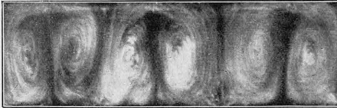
FIG. 11. — COUPE TRANSVERSALE DE TOURBILLONS CELLULAIRES CONVectifs DANS UN BAIN D'HUILE Cette photographie met en évidence le double mouvement ascendant et descendant du fluide chargé de poussière métallique.
