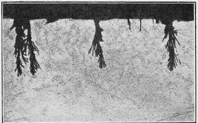
FIG. 9. — COUPE D'UN BARREAU D'ACIER A 12 % DE MANGANÈSE SOUMIS A DES FLEXIONS ALTERNÉES DANS DE L'EAU DE MER SYNTHÉTIQUE
