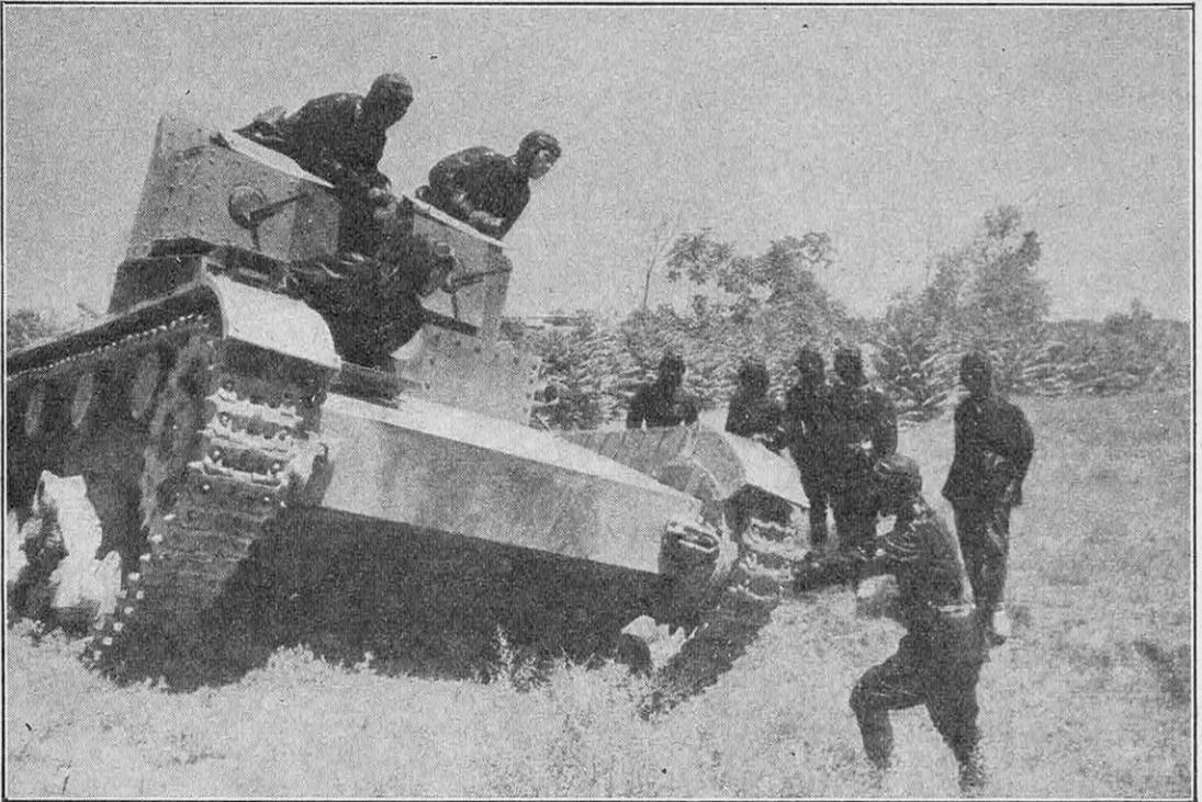
FIG. 4. — CHAR DE COMBAT RUSSE DE 7 TONNES MODÈLE « VICKERS-ARMSTRONG » (T 26)
