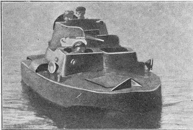
FIG. 2. — AUTOMOBILE BLINDÉE AMPHIBIE TYPE « FORD », CONSTRUITE EN U. R. S. S.
