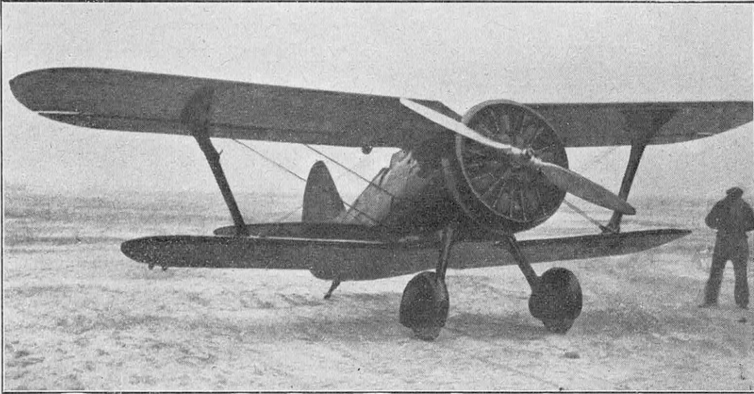
FIG. 2. — VOICI LE MONOPLANE DE CHASSE « I.-15 », A MOTEUR « WRIGHT-CYCLONE » DE 700 CH A COMPRESSEUR, QUI, CONSTRUIT EN GRANDE SÉRIE, ÉQUIPE ACTUELLEMENT LES FORMATIONS AÉRIENNES DE L'ARMÉE SOVIÉTIQUE
