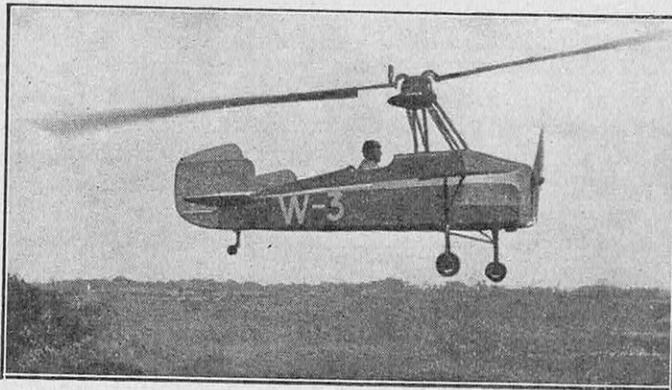
L'AUTOGIRE « LA CIERVA » EFFECTUANT UN DÉCOLLAGE DIRECT (SANS ROULER) SUR LE TERRAIN D'EXPÉRIENCES DE HOUSSELOW HEATH, EN ANGLETERRE
