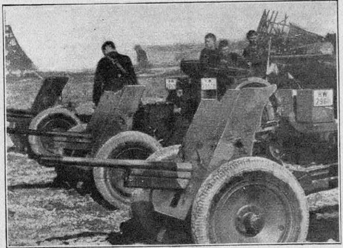
FIG. 6. — CANONS ALLEMANDS DE CALIBRE 37 MM, « TRACTÉS » PAR DES VOITURES « TOUTS TERRAINS » ET DESTINÉS SPÉCIALEMENT AU TIR CONTRE LES CHARS
