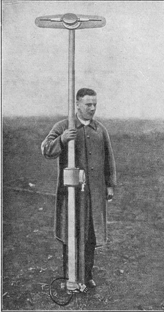
FIG. 2. — VOICI UN ÉMETTEUR A ONDES ULTRACOURTES (5 A 15 CM DE LONGUEUR D'ONDE) MONTÉ SUR POTEAU ET MUNI D'UN ÉCRAN RÉFLECTEUR DERRIÈRE L'ANTENNE
