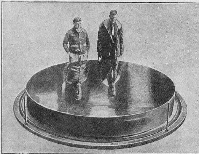
FIG. 3. — LE GRAND MIROIR DE 2 M 54 DE L'OBSERVATOIRE DU MONT WILSON, MÉTALLISÉ PAR L'ALUMINIUM
