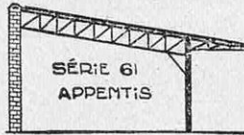
HANGAR AGRICOLE SIMPLE 5 à 22 mètres de portée. (Notice 144)
