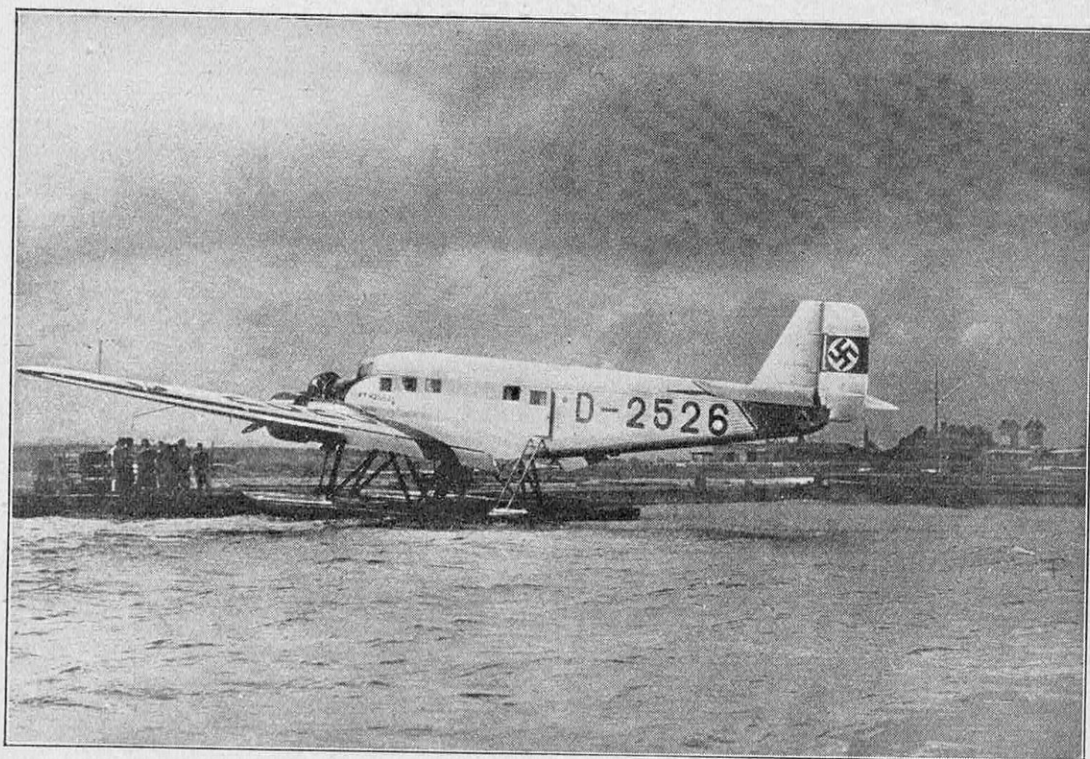
FIG. 1. — HYDRAVION ALLEMAND « JUNKERS-52 » MUNI DE TROIS MOTEURS A HUILE LOURDE Les caractéristiques de cet appareil sont : puissance, 1.800 ch ; charge utile (carburant et bombes), 3 tonnes ; vitesse de croisière, 230 km à l'heure ; poids total, 9 tonnes. Cet hydravion peut porter 300 kilogrammes de bombes à 700 kilomètres et rentrer à son point de départ.
